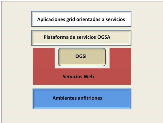
Figura 5.5 La arquitectura para aplicaciones de Grid de acuerdo al modelo OGSA. Esquema original de (Li y Baker, 2005). Traducción del inglés y edición del autor.
