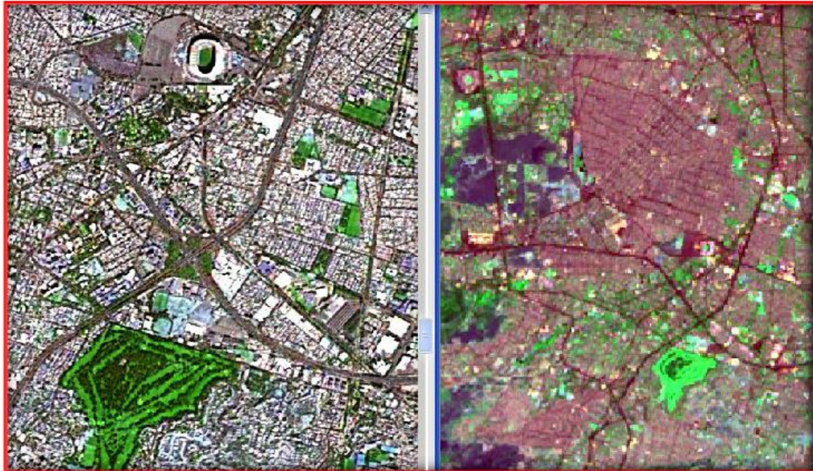
Figura 10. López, D. (2013). Tamaño de elementos en la imagen en dos resoluciones. Imagen Ikonos, resolución espacial 4m (Izquierda). Imagen Landsat 30m (Derecha). Obsérvese el ancho de las vías, el tamaño de algunas construcciones como el estadio que aparece en la parte superior derecha, en la imagen de Ikonos.
