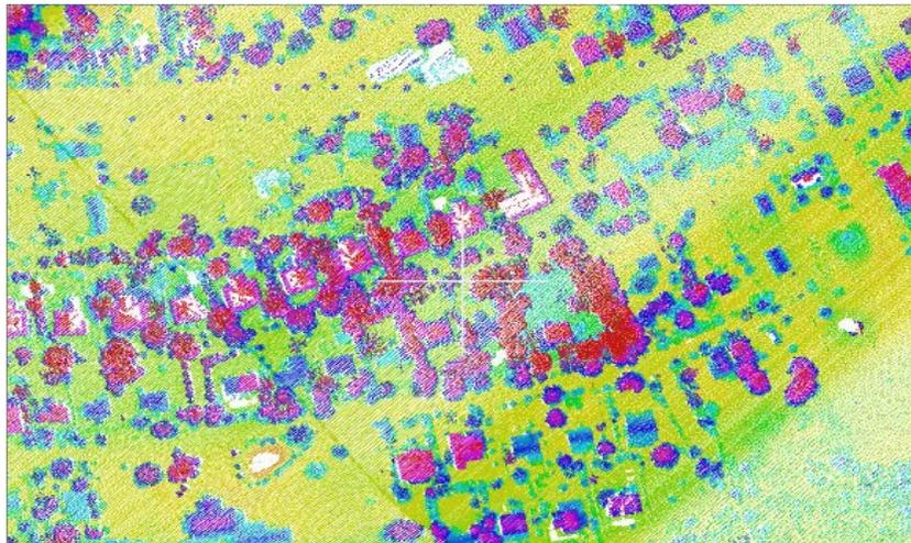
**Figura 3.6 Puntos coloreados por elevación. Tomado de: NOAA (2012)**
